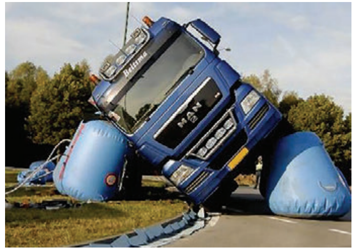
Buitink Technology maakt ook allerlei soorten opblaasbare hefkussens, die bijvoorbeeld gebruikt worden om omgevallen vrachtwagens weer overeind te zetten.
